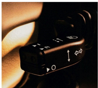
Entlastung auf langen Strecken. Mit dem elektronisch gesteuerten Geschwindigkeitsregler halten Sie automatisch Ihr Wunschtempo ein.
