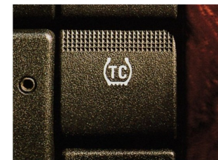
Traction Control, das heißt: perfekter Reifengriff auf jedem Belag. Bevor ein Rad durchdrehen kann, wird es elektronisch abgebremst (serienmäßig in Verbindung mit 2.0 16V ECOTEC- und 2.5 V6 ECOTEC-Motor).
