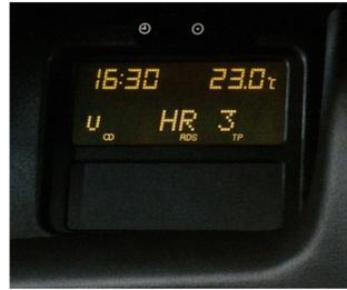
Das Triple-Info-Display ist serienmäßig in Verbindung mit Radio-Cassettengerät. So erfahren Sie alles digitalgenau, die Außentemperatur, die Radiosenderanzeige, das Datum. Die integrierte Uhr ist funksignalgesteuert und stellt sich automatisch von Sommer- auf Winterzeit um.
