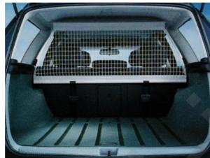
Das serienmäßige Sicherheitsnetz trennt Fabrgast- und Gepäckraum. Ein guter Schutz der Fahrzeuginsassen bei starken Bremsvorgängen.
