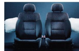
Die in die Sitzlehne integrierten Seiten-Airbags bieten zusammen mit den Stabrohrverstärkungen in den Türen einen optimalen Schutz bei seitlichen Kollisionen.
