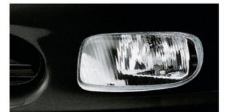
*Gelungene Verbindung von Sicherheit und Design: Die Nebelscheinwerfer im Vectra Caravan CD sind in die Stoßfänger integriert.*
