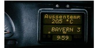
Das Multi-Info-Display: präzise, digitale Informationen über Uhrzeit, Radiofunktionen, Meldungen des Bordcomputers und des Opel Check-Control-Systems.
