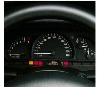
Die elektronische Steuerung des Tachometers macht es möglich, die Geschwindigkeit beim Vectra schon ab 4 km/h genau anzuzeigen, so daß sich Tempolimits besser einhalten lassen.
