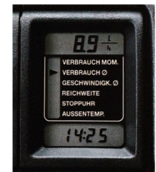
Ein Bordcomputer liefert ständig aktuelle Infos über den durchschnittlichen und den augenblicklichen Kraftstoffverbrauch, die Durchschnittsgeschwindigkeit, die Außentemperatur, die momentane Reichweite und natürlich die Uhrzeit. Darüber hinaus ist eine Stoppuhr integriert (Sonderausstattung).
