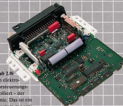
Alle Opel Motoren ab 2.0i werden von einem elektronischen Motorsteuersystem kontrolliert - der Bosch-Motronic. Das ist ein integriertes System zur optimalen Steuerung von Benzineinspritzung und Zündung. Es kann bis zu 500.000 Steuerbefehle pro Sekunde (!) verkraften. Bei Auftreten eines Fehlers stellt es automatisch die Ursache fest. So weiß der Opel Mechaniker bei der nächsten Inspektion sofort Bescheid - ohne lange zu suchen.
