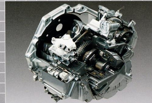
Eine intelligente Elektronik, das Engine Transmission Management (ETM), steuert die drei Programme in dem vollelektronischen 4-Gang-Automatic-Getriebe. Sie wählen „Power“ für schnelle Beschleunigung, „Economy“ für sparsames Fahren und „Winter“ für Schnee- und Eisfahrten. In der „Winter“-Position fährt Ihr Opel im lang übersetzten 3. Gang an. Dieses neuentwickelte Automatic-Getriebe ermöglicht erstmals ruckfreie Beschleunigung.
