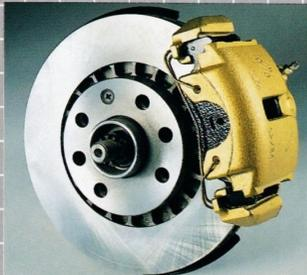
**Diagonales Zweikreisbremssystem** für den Vectra, mit Bremskraftverstärker und Bremskraftregler. Bei 1.6i- und 1.7-D-Motoren Scheibenbremsen vorn und Trommelbremsen hinten; bei 2.0i-Motor Scheibenbremsen vorn und hinten (vorn innenbelüftet). Asbestfreie Bremsbeläge.
