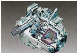
Ein neuer Maßstab für Allrad-Sicherheit: Permanenter Allradantrieb mit Schräglenker-Hinterachse und Einzelradaufhängung. Die Viskosekupplung macht eine variable Kraftübertragung von den Vorder- auf die Hinterräder möglich. Bei trockener Straße wird der Vectra 4x4 bis zu ca. 75 % über die Vorderräder angetrie-
