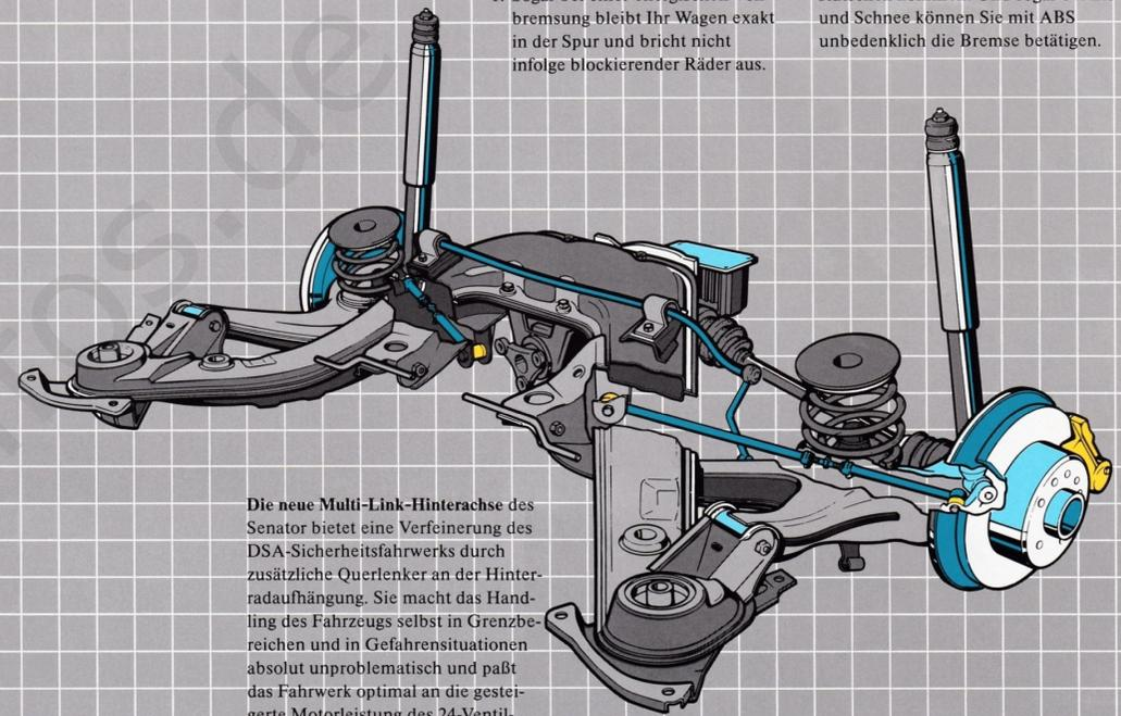
Die neue Multi-Link-Hinterachse des Senator bietet eine Verfeinerung des DSA-Sicherheitsfahrwerks durch zusätzliche Querlenker an der Hinteradaufhängung. Sie macht das Handling des Fahrzeugs selbst in Grenzbereichen und in Gefahrensituationen absolut unproblematisch und paßt das Fahrwerk optimal an die gesteigerte Motorleistung des 24-Ventil-Motors an.
